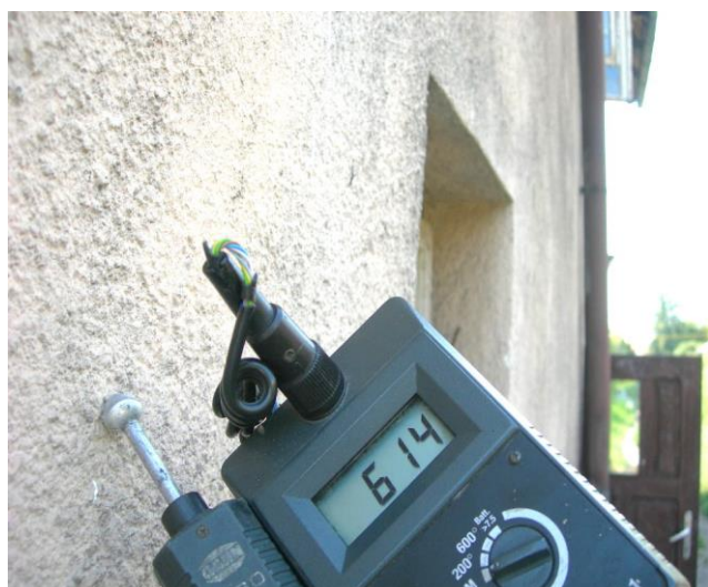
Zawilgocenie na wysokości 1,90m
