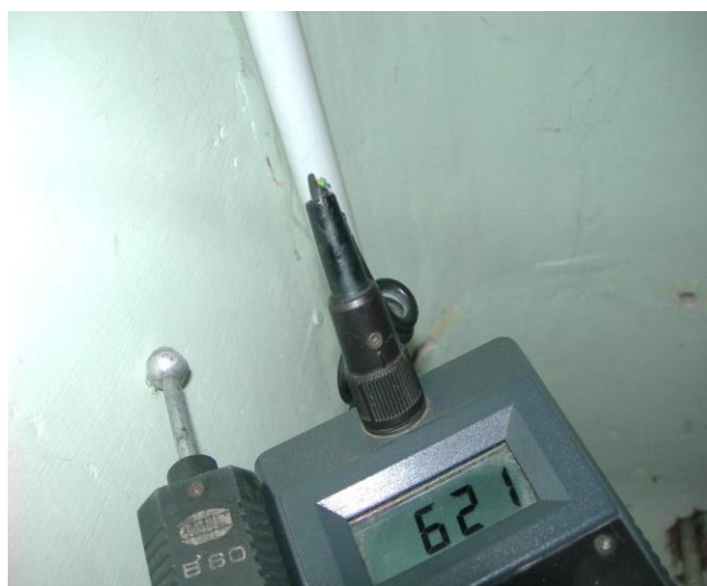
Zawilgocenie na wysokości 2,10m
