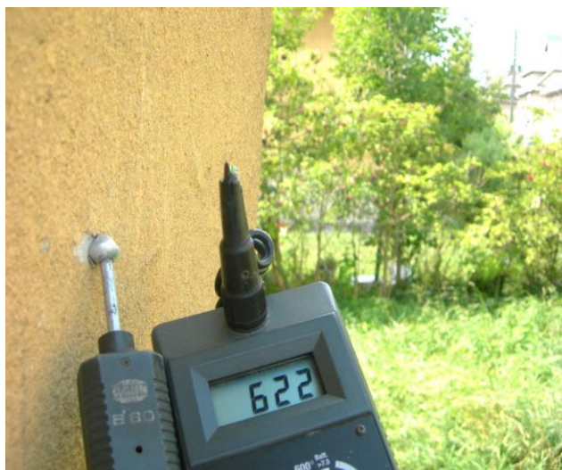
Zawilgocenie na wysokości 1,60m
