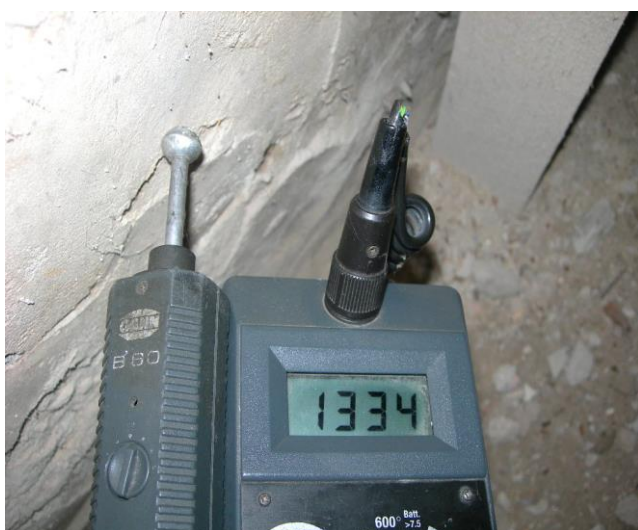
Wartość zawilgocenia, wysokość 0,40m
