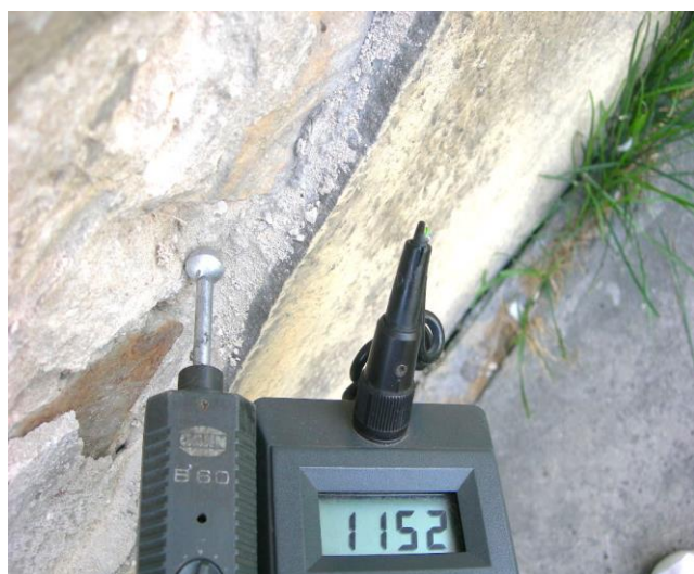
Zawilgocenie, ściana wewn. wys. ok. 0,40m
