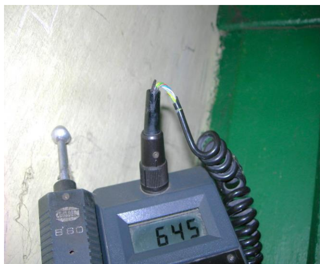
Zawilgocenie na wysokości ok. 1,70m
