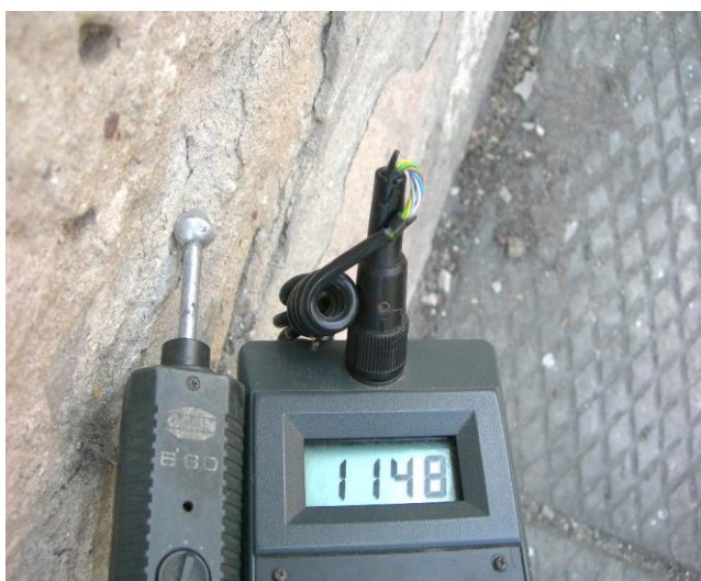
Wartość zawilgocenia, wysokość 0,50m
