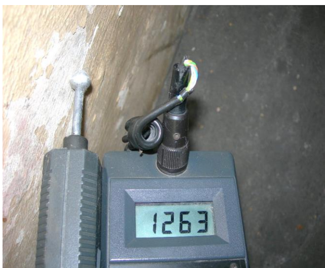
Wartość zawilgocenia, wysokość 0,40m
