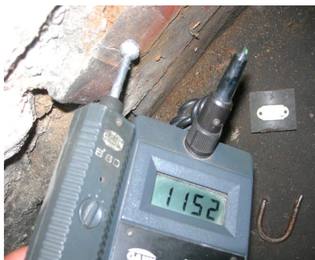
Wartość zawilgocenia, wysokość 0,20m
