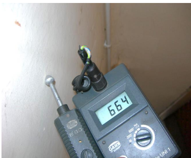
Zawilgocenie na wysokości ok. 2,30m
