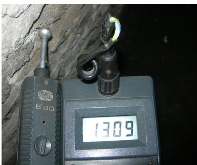
Wartość zawilgocenia, wysokość 0,40m
