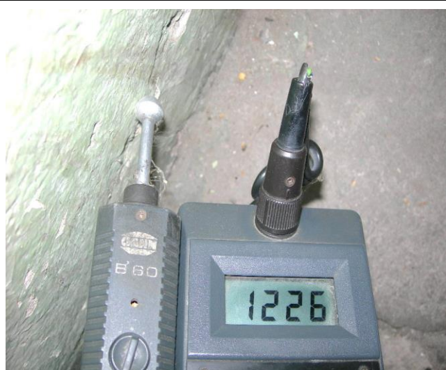
Wartość zawilgocenia, wysokość 0,10m
