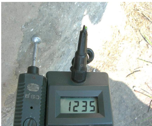
Pomiar zawilgocenia wys. ok. 0,30m
