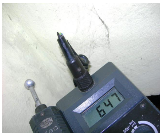
Zawilgocenie na wysokości 2,20m
