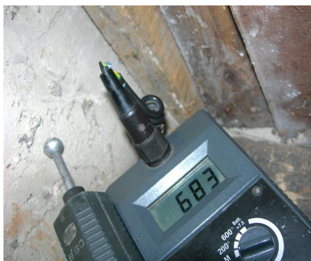
Zawilgocenie na wysokości ok. 1,90m
