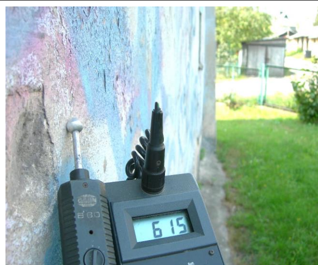
Zawilgocenie na wysokości 1,40m
