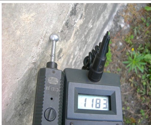
Zawilgocenie, ściana wewn. wys. ok. 0,30m
