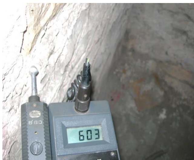
Zawilgocenie na wysokości ok. 1,60m
