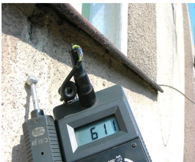
Zawilgocenie na wysokości 2,30m
