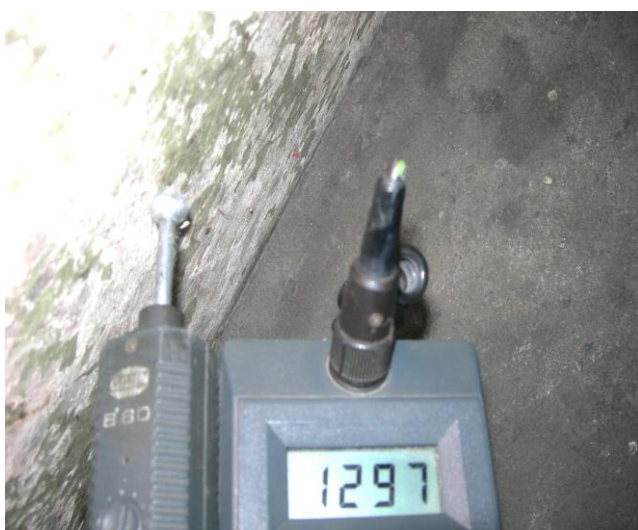
Wartość zawilgocenia, wysokość 0,20m
