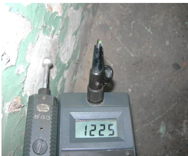
Wartość zawilgocenia, wysokość 0,20m
