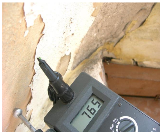
Zawilgocenie na wysokości 2,00m
