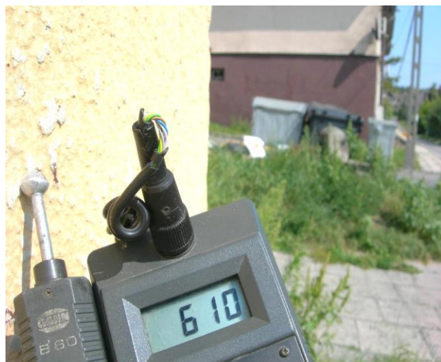
Zawilgocenie, ściana wewn. wys. ok. 0,20m
