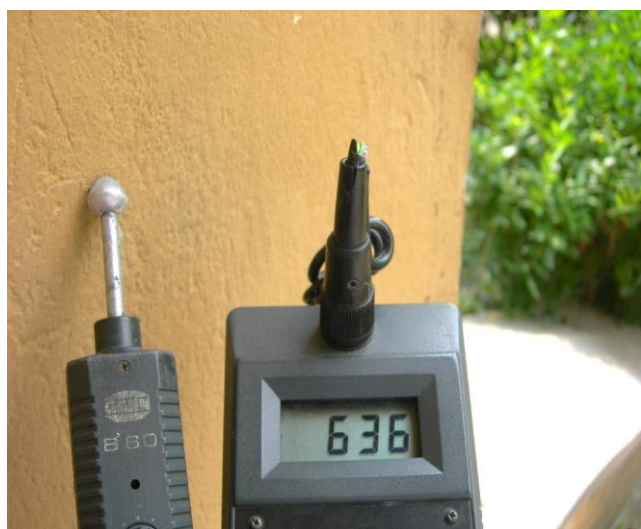
Zawilgocenie na wysokości 1,30m
