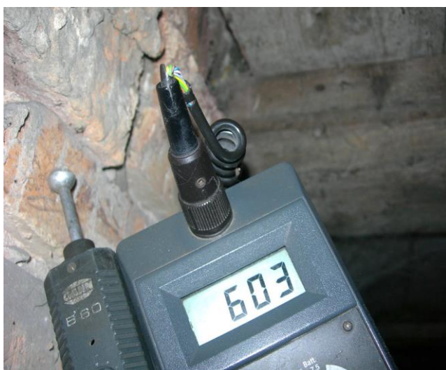
Wartość zawilgocenia, wysokość 0,40m
