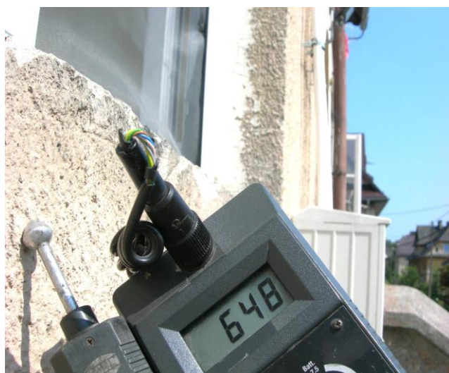
Zawilgocenie na wysokości 2,30m
