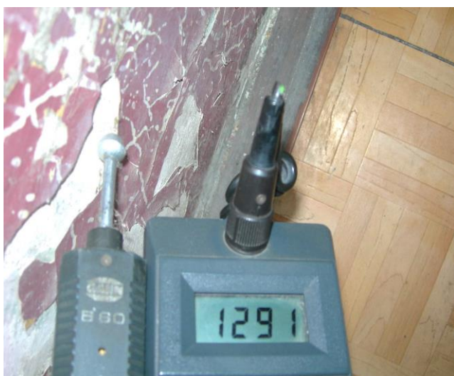
Wartość zawilgocenia, wysokość 0,30m
