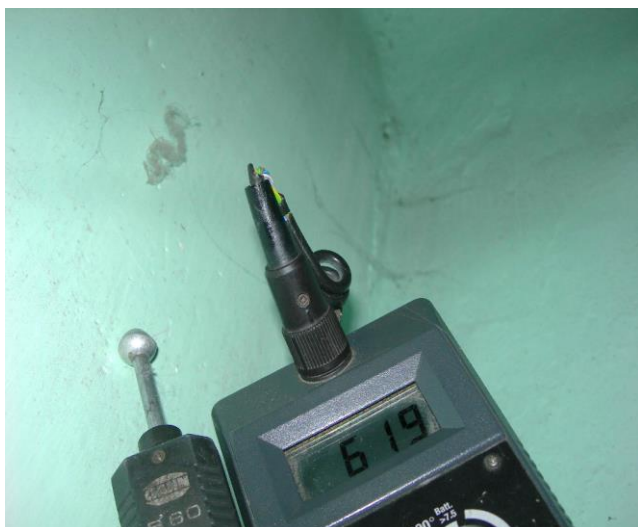
Zawilgocenie na wysokości ok. 2,20m
