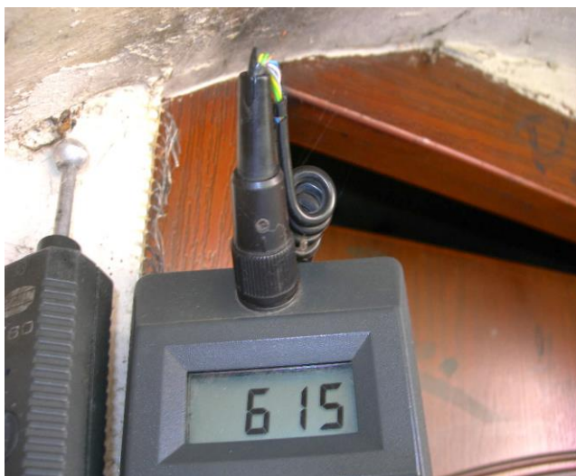
Zawilgocenie, ściana wewn. wys. ok. 0,60m
