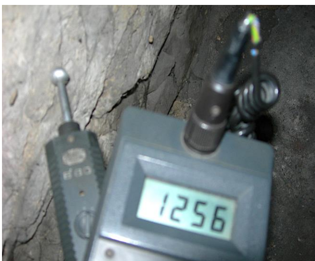
Wartość zawilgocenia, wysokość 0,20m
