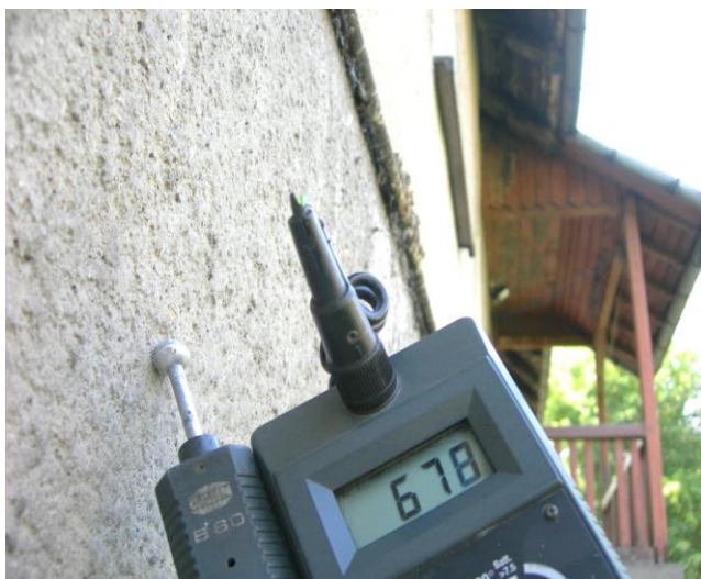
Zawilgocenie na wysokości ok. 2,20m
