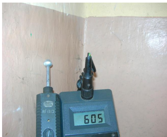
Zawilgocenie na wysokości ok. 1,60m
