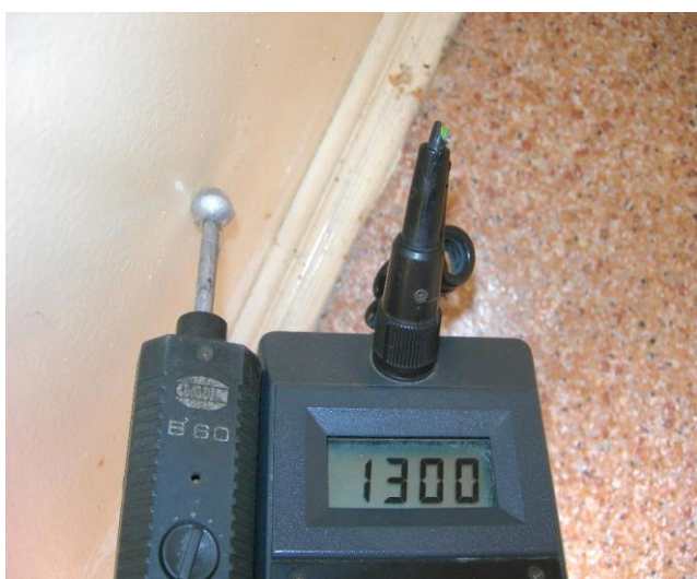
Wartość zawilgocenia, wysokość 0,20m
