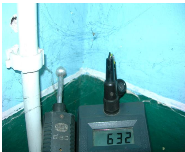
Zawilgocenie na wysokości ok. 1,50m
