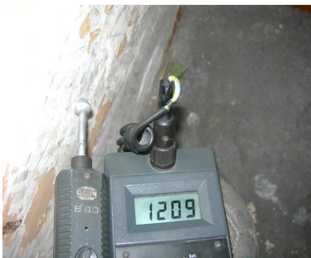
Wartość zawilgocenia, wysokość 0,30m
