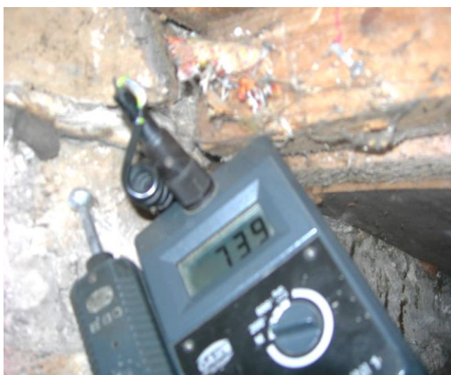
Zawilgocenie na wysokości ok. 1,70m
