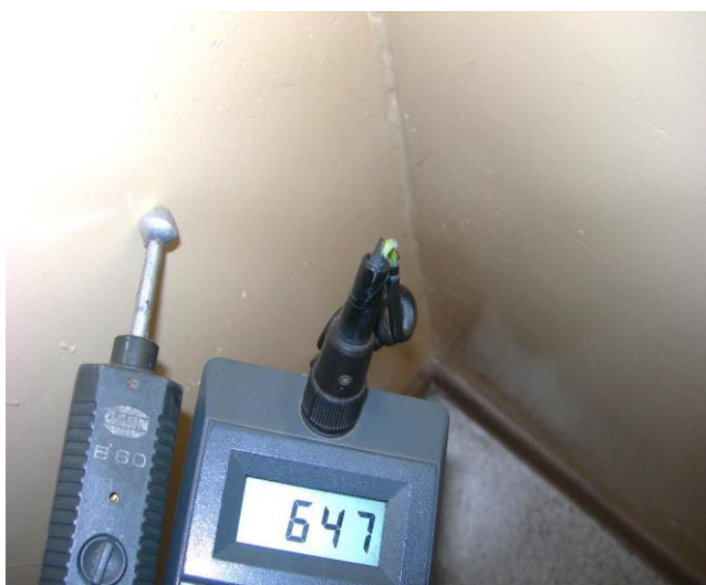
Zawilgocenie na wysokości ok. 0,80m
