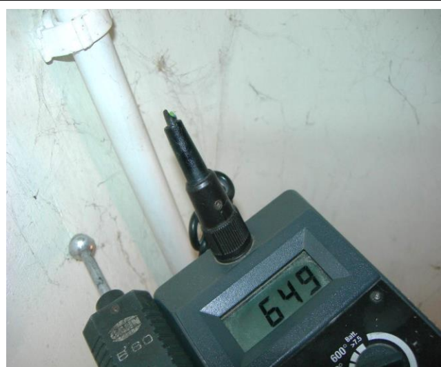
Zawilgocenie na wysokości 2,30m
