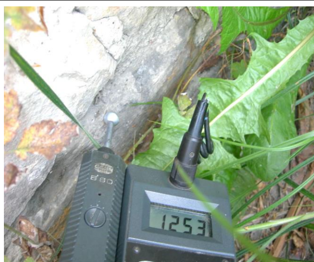
Zawilgocenie, ściana zewn. wys. ok. 0,20m
