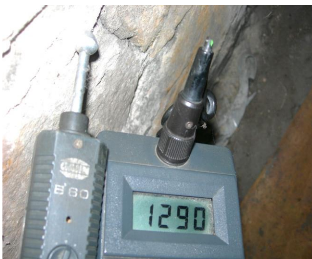
Wartość zawilgocenia, wysokość 0,40m
