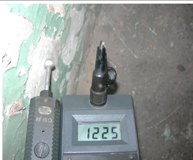
Wartość zawilgocenia, wysokość 0,20m
