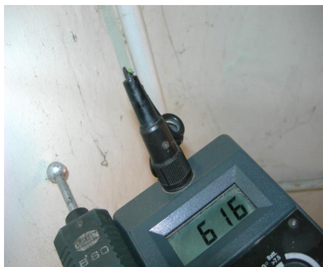
Zawilgocenie na wysokości ok. 2,20m
