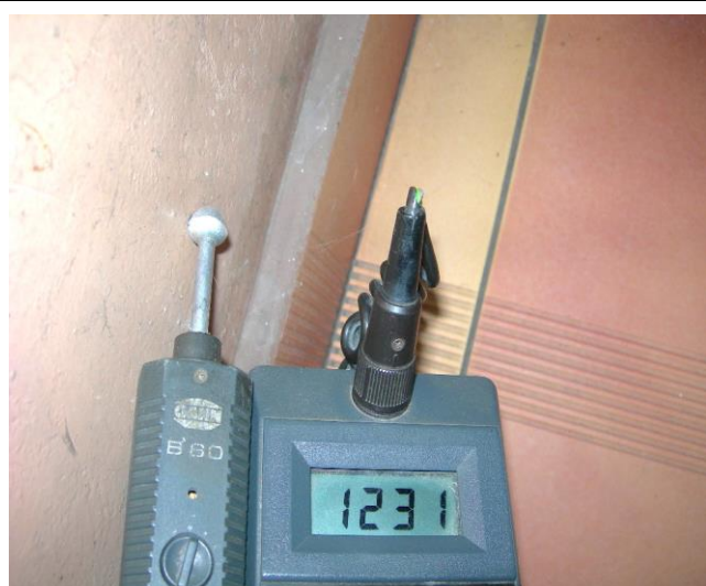
Wartość zawilgocenia, wysokość 0,20m
