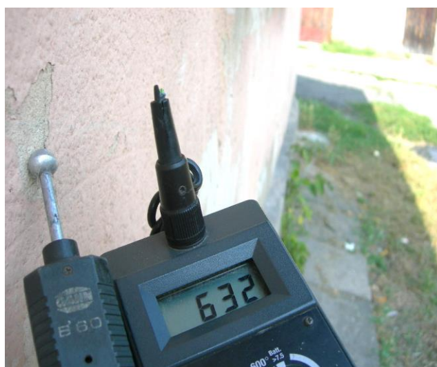
Zawilgocenie na wysokości 1,50m
