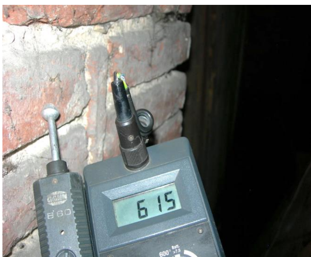
Zawilgocenie na wysokości ok. 1,60m
