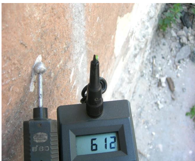
Zawilgocenie na wysokości 1,10m
