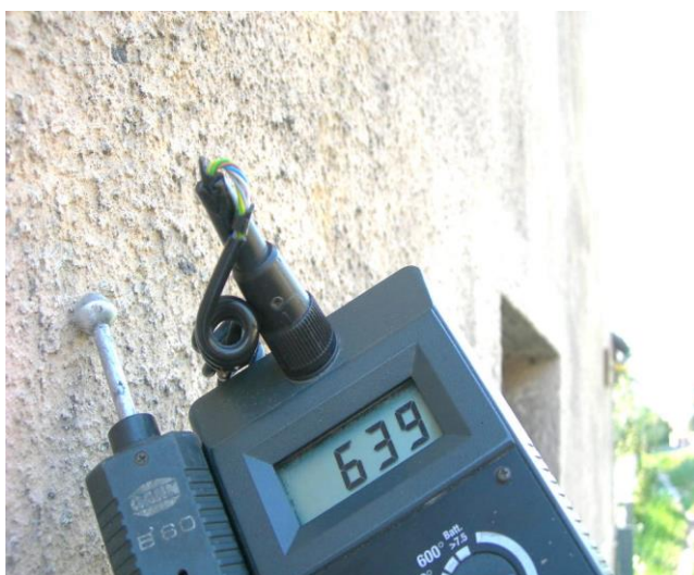
Zawilgocenie na wysokości ok. 2,10m
