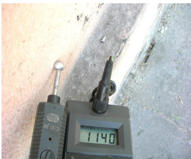
Zawilgocenie, ściana wewn. wys. ok. 0,60m
