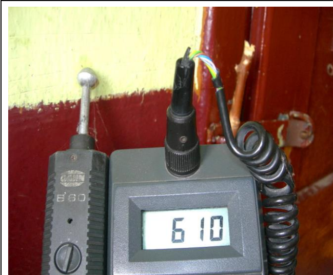
Wartość zawilgocenia, wysokość 0,20m
