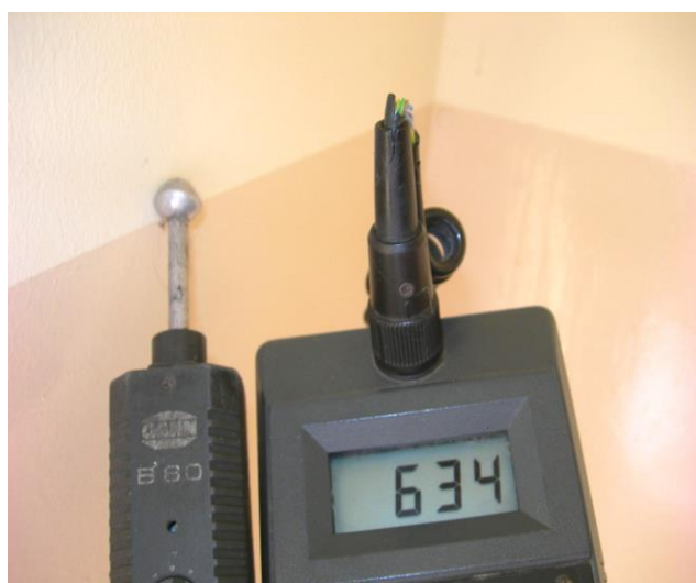
Zawilgocenie na wysokości 1,50m
