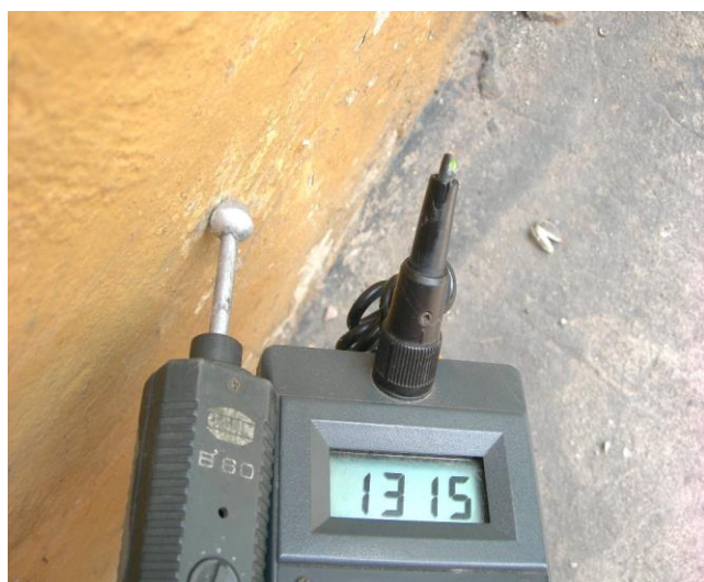
Zawilgocenie, ściana wewn. wys. ok. 0,10m
