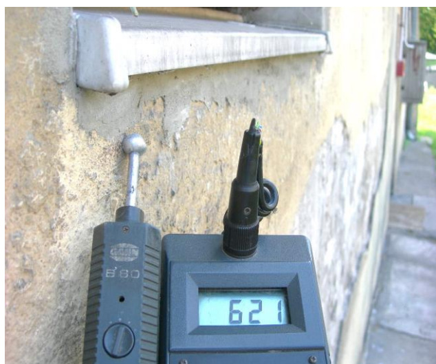
Zawilgocenie na wysokości 1,60m
