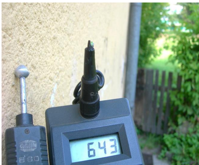
Wartość zawilgocenia, wysokość 0,30m
