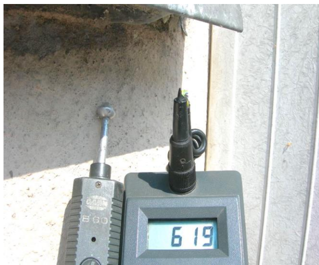
Zawilgocenie na wysokości ok. 1,90m
