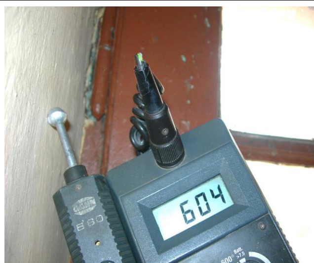
Zawilgocenie na wysokości 1,90m
