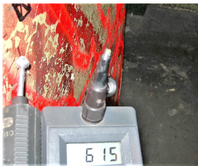
Zawilgocenie na wysokości 1,30m
