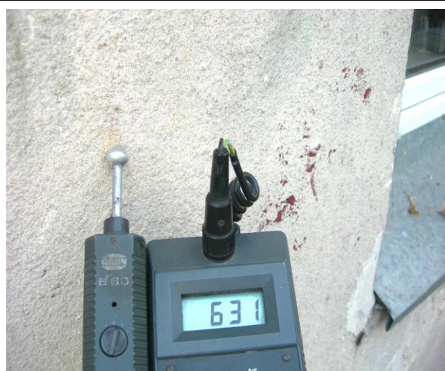
Zawilgocenie na wysokości 1,20m
