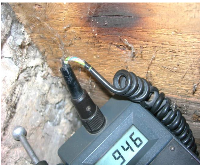
Zawilgocenie na wysokości ok. 1,80m
