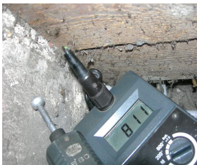
Zawilgocenie na wysokości ok. 1,80m
