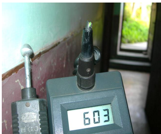
Zawilgocenie na wysokości 1,50m
