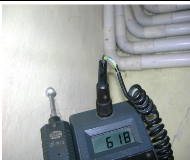
Zawilgocenie na wysokości 2,10m
