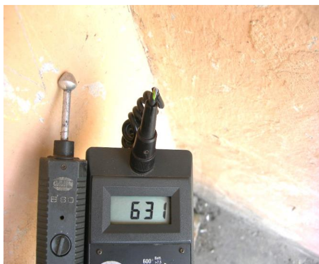
Zawilgocenie na wysokości 2,40m
