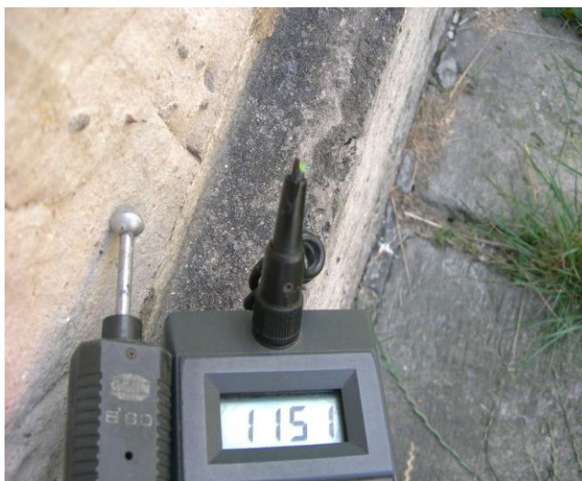
Zawilgocenie, ściana wewn. wys. ok. 0,60m
