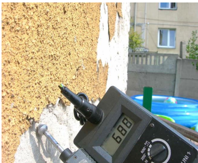
Wartość zawilgocenia, wysokość 0,20m
