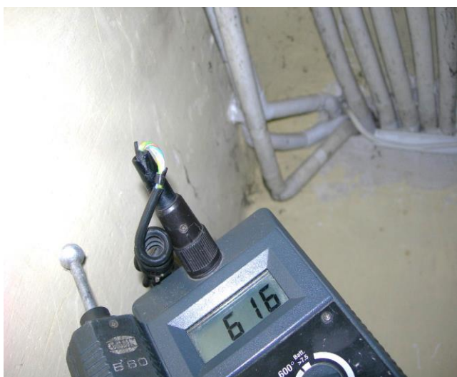
Zawilgocenie na wysokości ok. 2,30m
