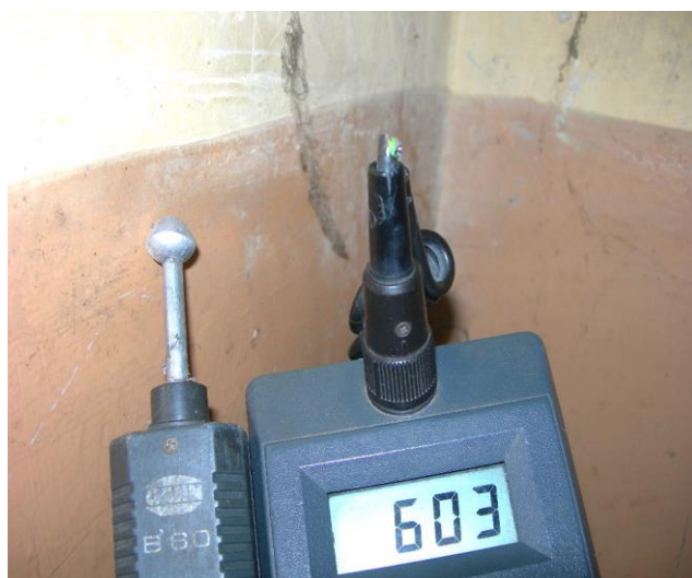
Zawilgocenie na wysokości 1,50m
