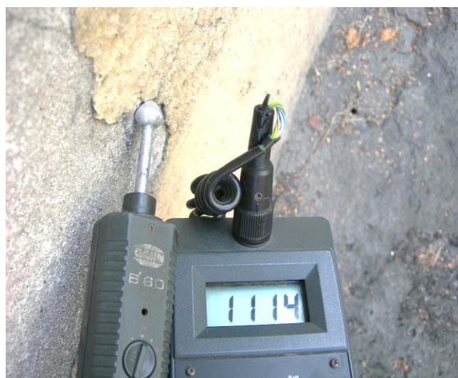
Zawilgocenie, ściana wewn. wys. ok. 0,20m
