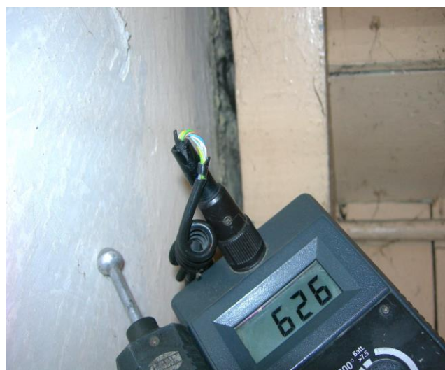
Zawilgocenie na wysokości 2,00m
