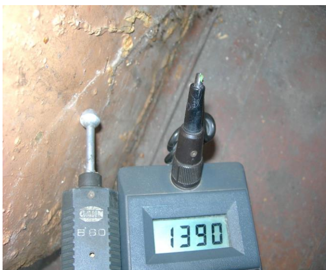
Wartość zawilgocenia, wysokość 0,20m
