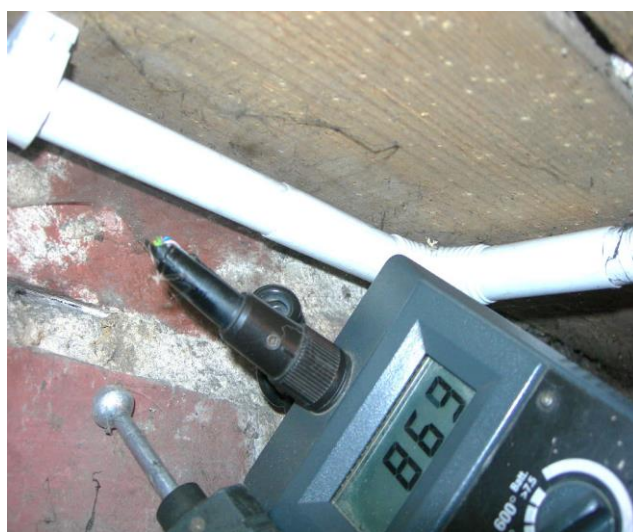
Zawilgocenie na wysokości 1,70m
