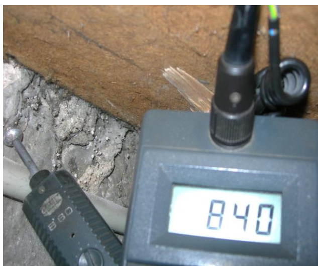
Zawilgocenie na wysokości 1,80m
